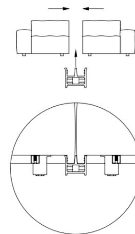
Ganci per l'assemblaggio elementi con piedini in acciaio Inox.
