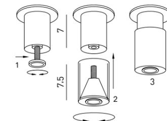
Ganci per l'assemblaggio elementi con piedini in PVC
